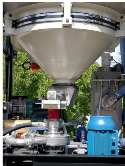
Tolva, tornillo dosificador y PSU (unidad de hidratación de FR en polvo)
